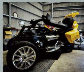
納車前にはカウルをバラし、念入りに納車整備とチェックを行い、安心してユーザーに届けるのがスリーホイールジャパンのやり方。こうして納車前にバラバラにし、各部を確認しながら再度組みつけてゆくの、車両購入と同時にオプションパーツを組み込むのが工賃を安くするポイントだと代表の岡本さんが話してくれた。
